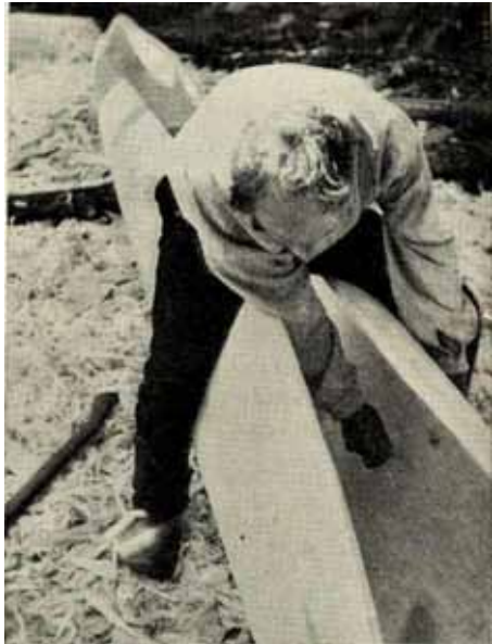
Kuva 9. Laitojen vahvuutta mitataan naskalilla.
