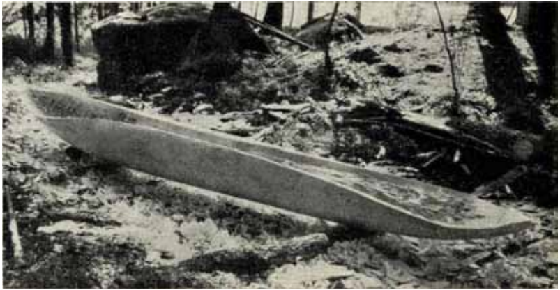
Kuva 5. Ruuhen teelmä ennen telsousta. Sekä perästä että keulasta hakataan kirveellä poikittaissuuntaan niin syvältä kuin kirves antoi myöten.
