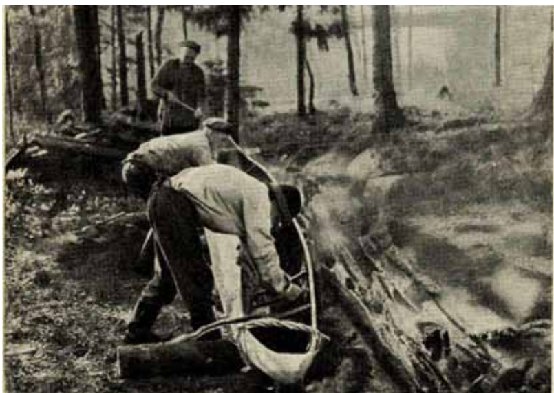
Kuva 12. Ruuhun toisen laidan levitystyö käynnissä.
