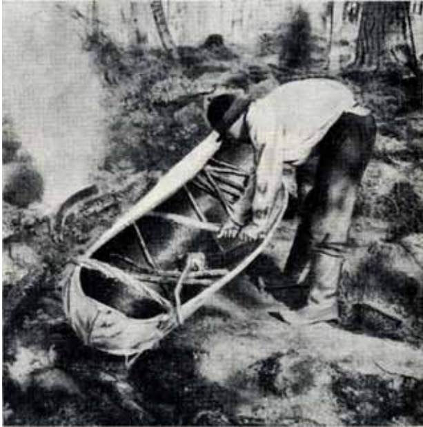
Kuva 13. Toista laitaa levitetään. Kuvassa näkyy hyvin nyttien asento. Etualalla on pitkävartinen tervasuti.
