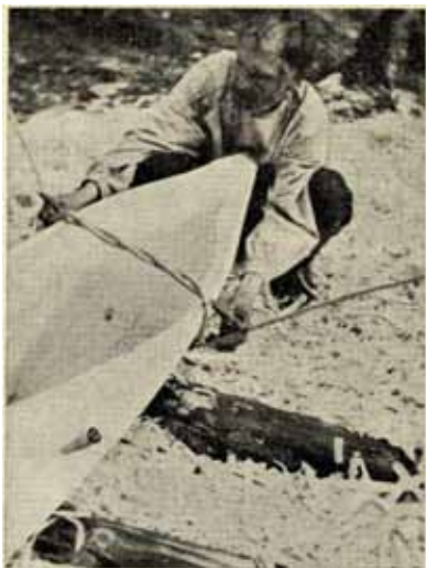
Kuva 10. Kumpaankin päähän pannaan koivuiset v itta-peruks e t, etteivät laidat levitettäessä pääse repeilemään.
