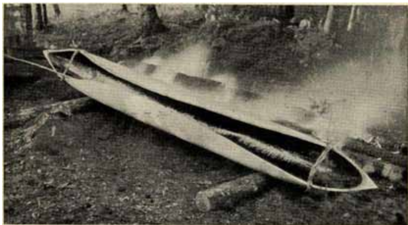
Kuva 11. Haaparuuhun teelmä lämpiämässä levitystä varten. Huom. vittaperukset kummassakin päässä sekä selvästi näkyvät kavahöylän jäljet.
